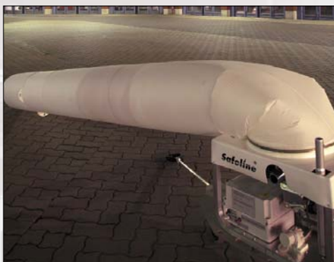
С помощью двух мощных нагнетателей шланг заполняется воздухом, поднимается вверх и может на тележке подвозиться к любому месту, где требуется освещение. Башню можно передвигать в рабочем состоянии.
