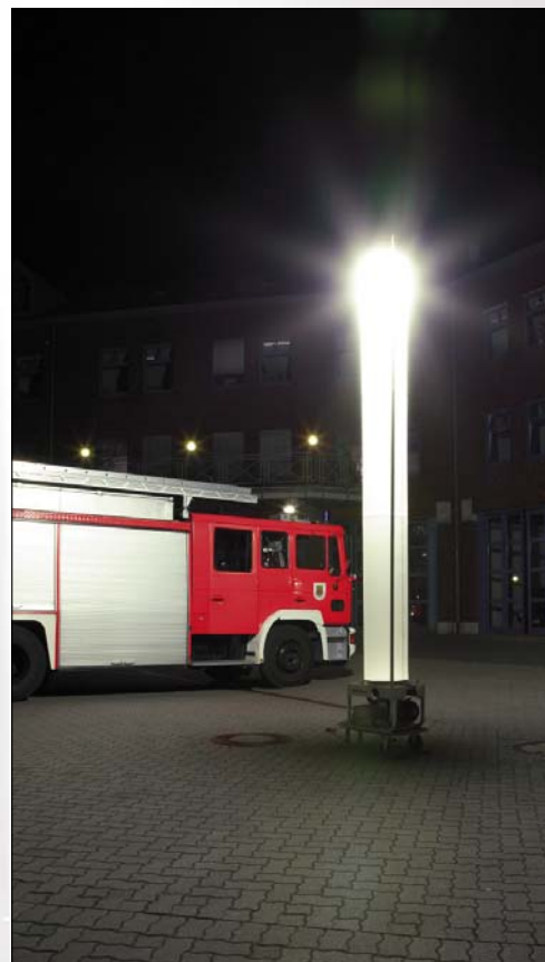
С помощью двух мощных нагнетателей шланг заполняется воздухом, поднимается вверх и может на тележке подвозиться к любому месту, где требуется освещение. Башню можно передвигать в рабочем состоянии.
